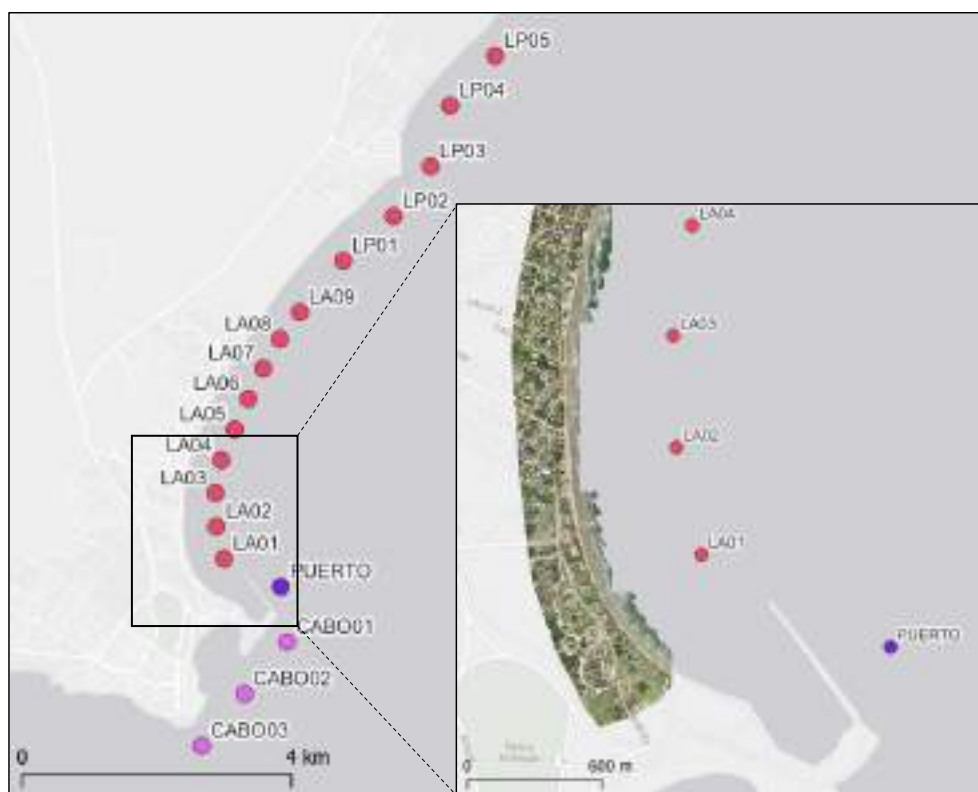
Figura 4-10 – Ubicación de nodos de referencia en los que se saca el oleaje frente al arco de playa de La Aguada.
