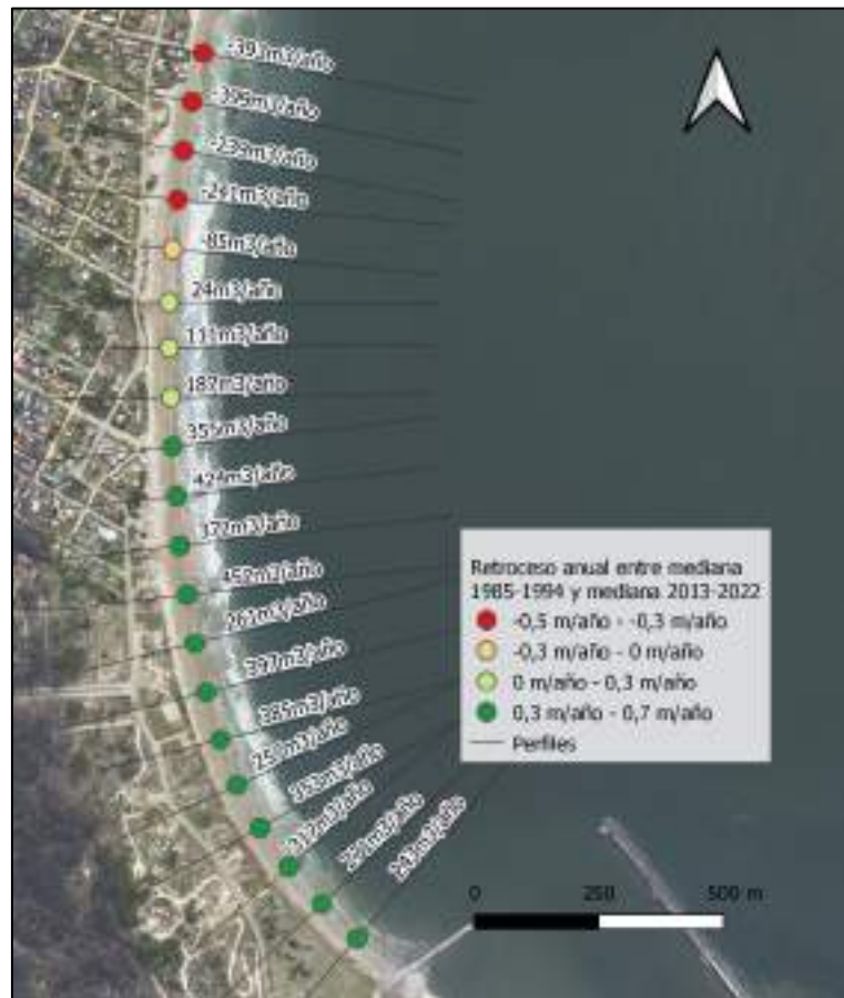
Figura 4-19 – Tasas anuales de erosión/acreción en cada perfil, expresadas en términos de cambio en la posición de la línea de costa (m/año) y cambio de volumen (m 3 /año). Valores negativos (positivos) corresponden a erosión (acreción).
