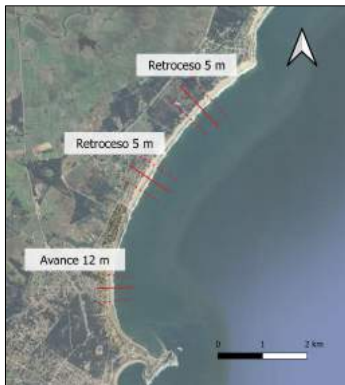
Figura 4-21 – Cambio en la posición de la línea de costa entre mediana 1985-1994 y mediana 2013-2022, calculada para tres perfiles a lo largo del arco de playa La Paloma – La Pedrera. Cada perfil es representativo de 600 m de costa.
