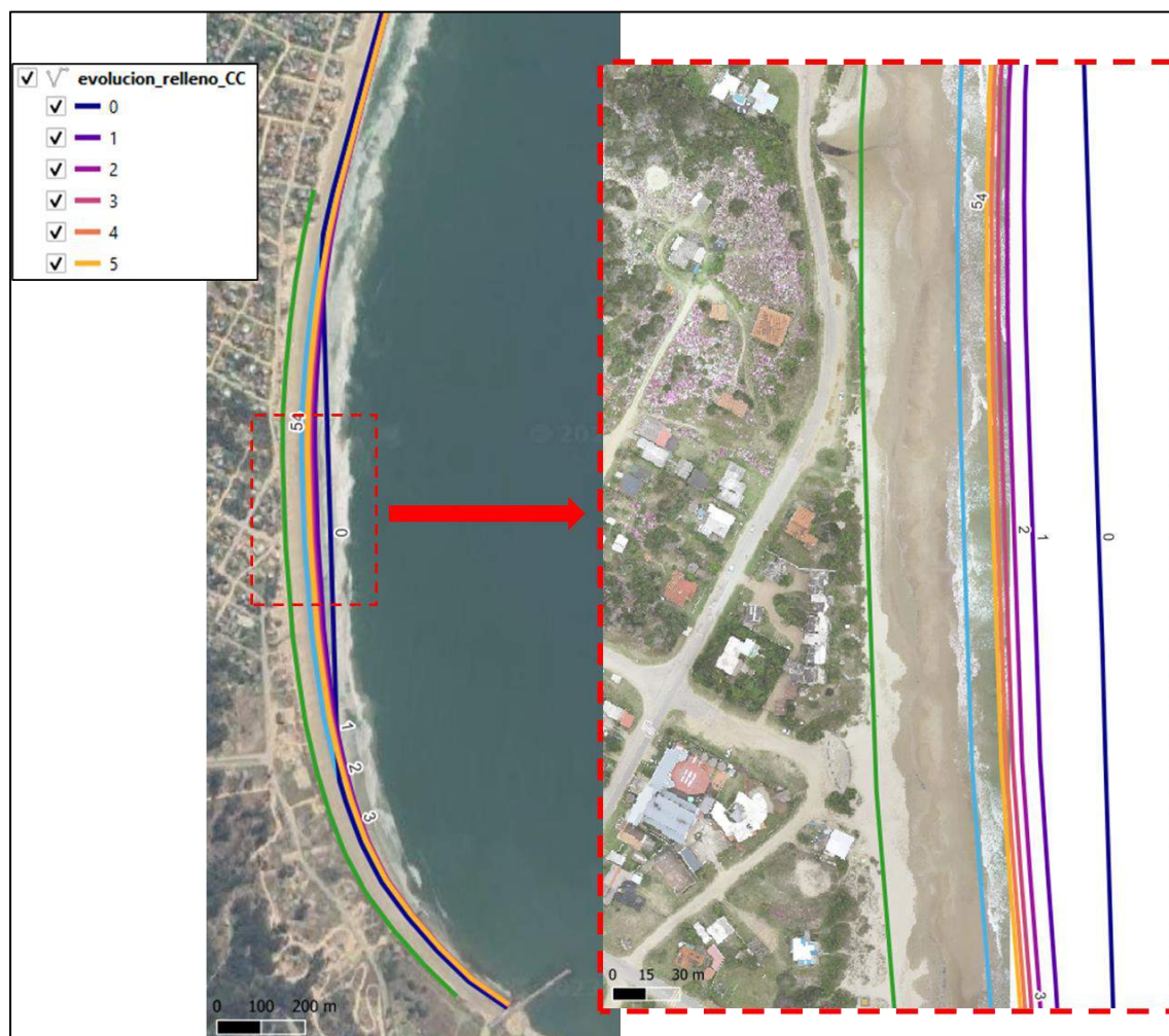
Figura 4-73 – Evolución de la línea de costa en los 5 años posteriores al relleno para el caso de avance inicial de 60 m.
